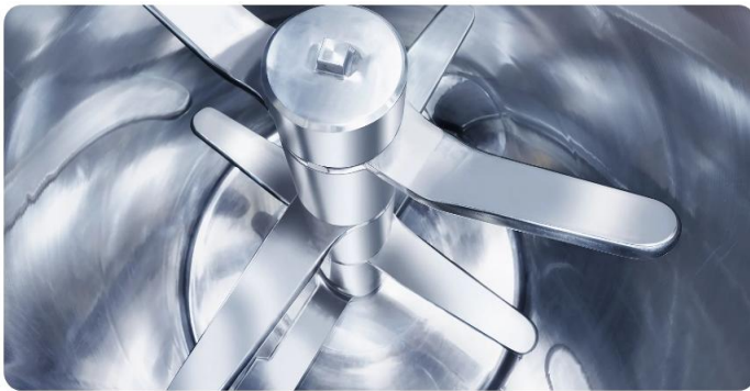
Abbildung 2 Beispiel für den Werkzeugaufbau im Heizmischer. Quelle: Mixaco
